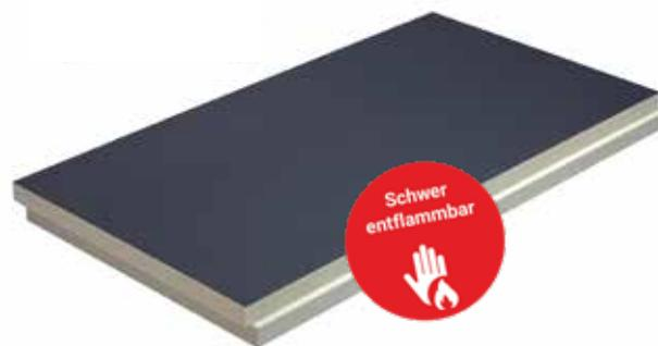
Die innovative Flachdachdämmung **puren® Secure** mit oberseitig flammhemmender Spezialvliesbeschichtung (schwer entflammbar nach DIN EN 13501-1) für brandsichere und diffusionsoffene Flach- und Gefälledachkonstruktionen.
