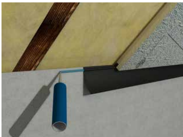
obr.č.3. Vzduchotěsné napojení napojovacího lemu z parozábrany na vnitřní omítku, např. pomocí lepicího tmelu puren Fix.
