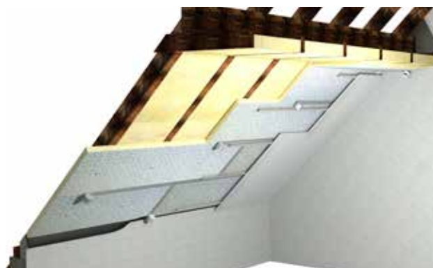
Pokládka izolačních desek a vzduchotěsné lepení spojí izolačních desek. Připevnění vnitřního obložení k latím.
